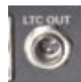
LTC OUT (纵向时间码输出) 端口 微型XLR接口，用于输出外部纵向时间码信息。
