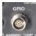
GPIO 端口 八引脚接口，用于额外的通用信号输入和输出连接。
